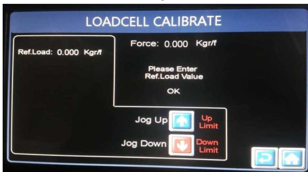
شکل ۱۴- پیغام جهت وارد کردن نیروی لودسل مرجع.
